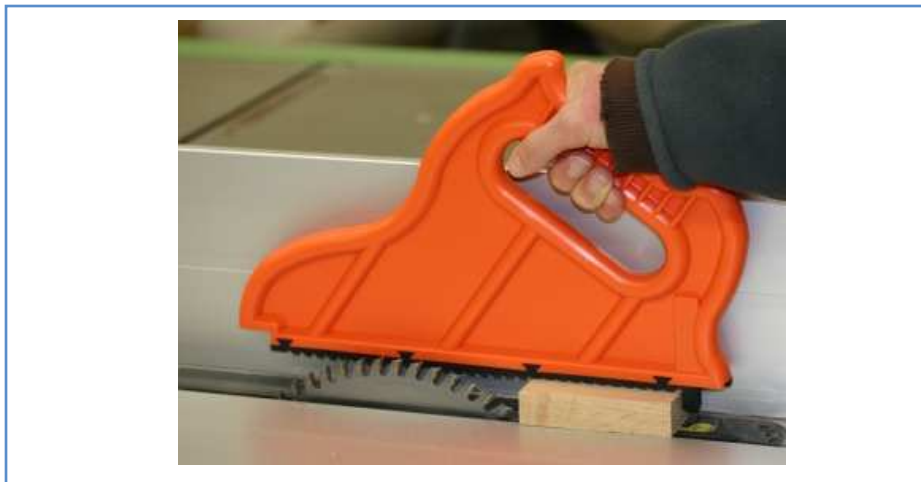
شکل ۴: کاربرد دسته مخصوص هل دادن چوب به هنگام استفاده از اره مدور
